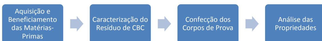
**Figura 1.** Fluxograma do procedimento experimental que foi utilizado para produção e caracterização da mistura de solo-cimento.
